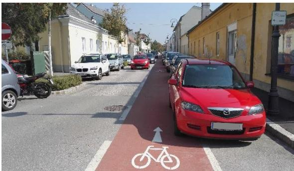
Abbildung 88: Fahrradstreifen gegen die Einbahn in der Wiener Straße auf Höhe Nr. 2, Blickrichtung Nordosten
